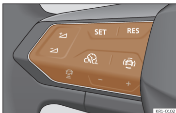
Abb. 122 Am Multifunktionslenkrad: Tasten zur ACC-Bedienung.
