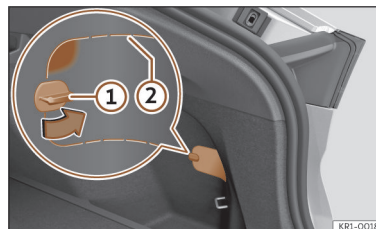
Abb. 61 Im unteren rechten Bereich der Kofferraumverkleidung: Abdeckung mit Trennlinien.
