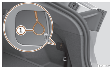
Abb. 62 Hinter der Abdeckung: Notentriegelung des Ladesteckers.
