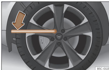
Abb. 206 Radwechsel: Radschrauben lockern.
