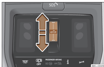
Abb. 101 Im Dachhimmel: Funktionsfläche zur Bedienung des Sonnenschutzrollos.
