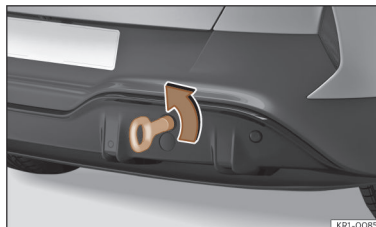
Abb. 190 Auf der rechten Seite des hinteren Stoßfängers: Eingeschraubte Abschleppöse.
