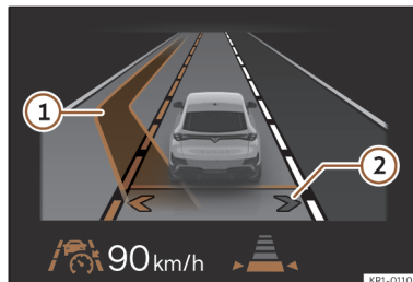
Abb. 132 Im Display des Kombi-Instruments: Anzeige des assistierten Spurwechsels (schematische Darstellung).
