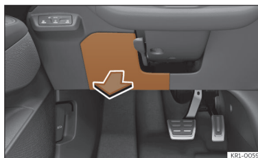
Abb. 191 Auf der Fahrerseite in der Instrumententafel: Abdeckung des Sicherungskastens.
