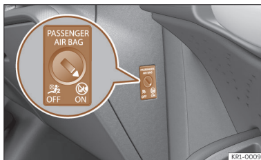
Abb. 27 Schlüsselschalter zum Ein- und Abschalten des Beifahrerairbags.
