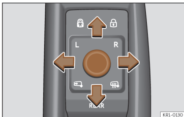
Abb. 99 Ausschnitt der Fahrertür: Außenspiegelbedienung.
