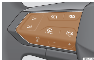
Abb. 119 Am Multifunktionslenkrad: Tasten zur Bedienung des Geschwindigkeitsbegrenzers.
