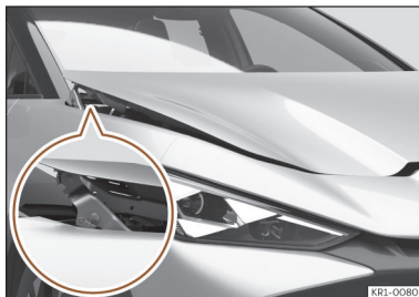
Abb. 46 Aktive Frontklappe angehoben
