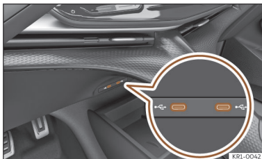
Abb. 158 An der Mittelkonsole: USB-Eingang.
