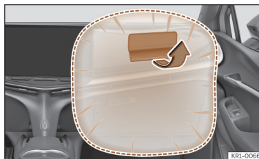
Abb. 26 Beifahrerairbag in der Instrumententafel
