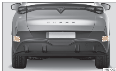
Abb. 115 Bereich hinter dem Fahrzeug: Bereiche der Radarsensoren.
