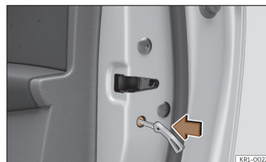
Abb. 75 Notfallsperre der Tür.
