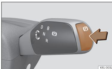
Abb. 137 Am Fahrstufenschalter: Taste der elektronischen Parkbremse.
