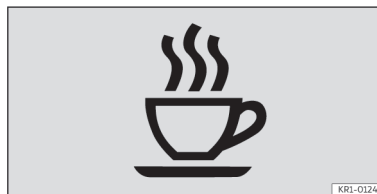
Abb. 5 Am Bildschirm des Kombi-Instruments: Symbol des Müdigkeitsmonitors.
