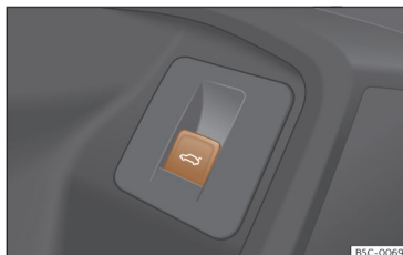
Abb. 78 An der Fahrertür: Taste zum Öffnen und Schließen der Heckklappe.
