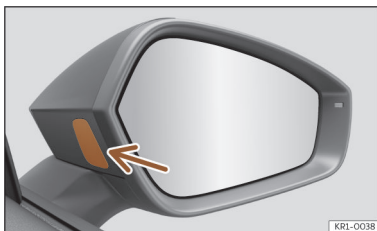
Abb. 134 Kontrollleuchte des Spurwechselassistenten.
