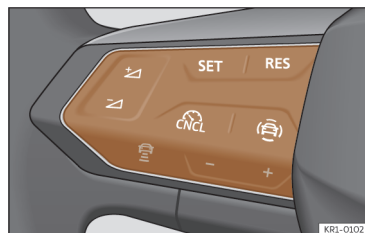
Abb. 118 Am Multifunktionslenkrad: Tasten zur Bedienung der Geschwindigkeitsregelanlage.
