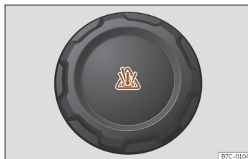
Abb. 198 Frontraum: Verschlussdeckel des Kühlmittelausgleichsbehälters.
