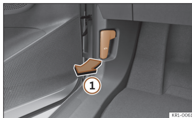
Abb. 195 Entriegelungshebel im Fahrerfußraum.
