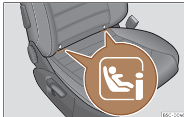
Abb. 38 Beifahrersitz: Einbauort der Halteösen i-Size.
