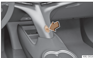
Abb. 45 Mittelkonsole: Schalter für die Warnblinkanlage.
