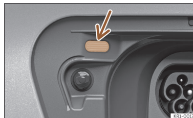
Abb. 59 Hinter der Batterieklappe: Ladevorgangsanzeige.
